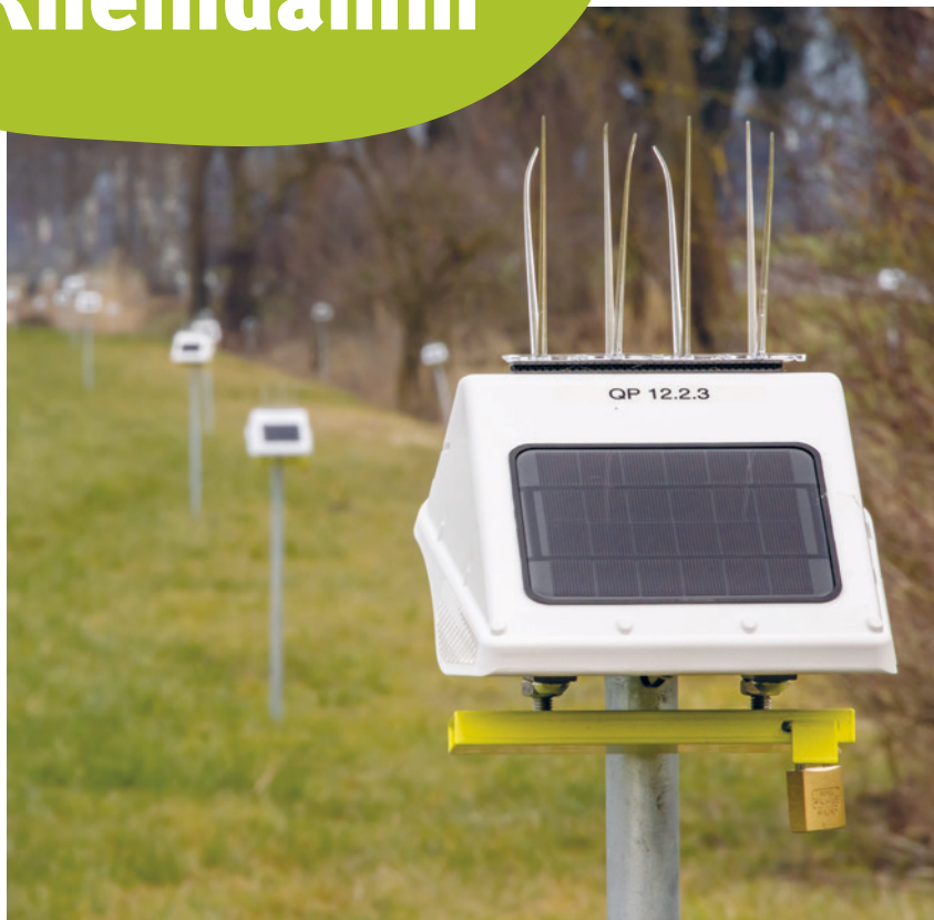
Base Time Locator überwachen Bewegungen im torfigen Boden.
