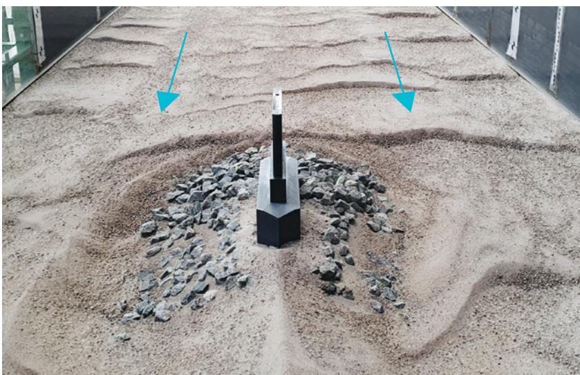
Ein birnenförmiger Steinteppich mit Wasserbausteinen wird um den Brückenpfeiler herum angelegt. Im Oberwasser, also vorne, wo die Beanspruchung am grössten wird, ist der Steinteppich breiter und besteht aus drei Lagen Wasserbausteinen. Diese wiegen 2–3 Tonnen. Ab der Mitte des Brückenpfeilers wird der Steinteppich schmaler, ist zweilagig und mit 1–1,5 Tonnen schweren Wasserbausteinen versehen.
